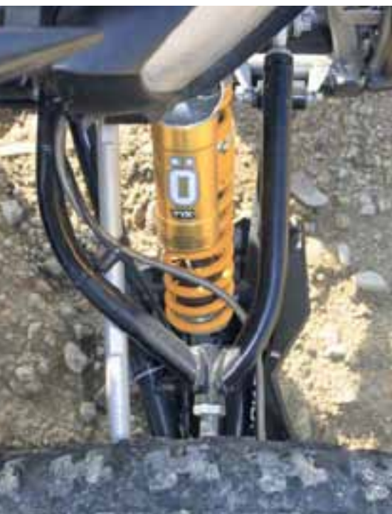
Das Fahrwerk kann sich sehen lassen: Öhlins TTX Longtravel-Racing-Fahrwerk.
