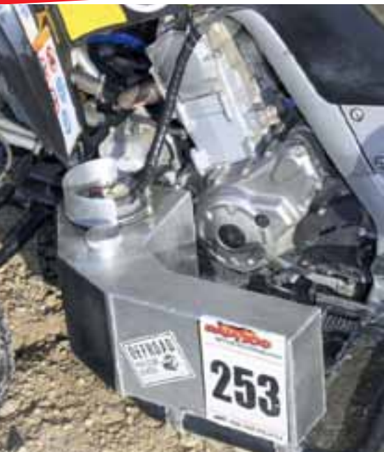
Der Motor nach der Kur: Hubraum: 686 ccm, Leistung: 62 PS, Drehzahl: 9.500 UpM, Drehmoment: 71 Nm. Macht Toppespeed bis zu 140 km/h möglich (je nach Übersetzung).
